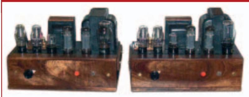
anodica più modesto senza avere più la notevole dissipazione di calore del ripartitore a resistenze. Le valvole stabilizzatrici, sono delle valvole a scarica nel gas rarefatto contenuto, una specie di lampadina al neon, che stabilizza la tensione e con correnti ammissibili di 5-40 mA (tipo OD3, equivalenti alle VR150). Lo zoccolo è octal.
